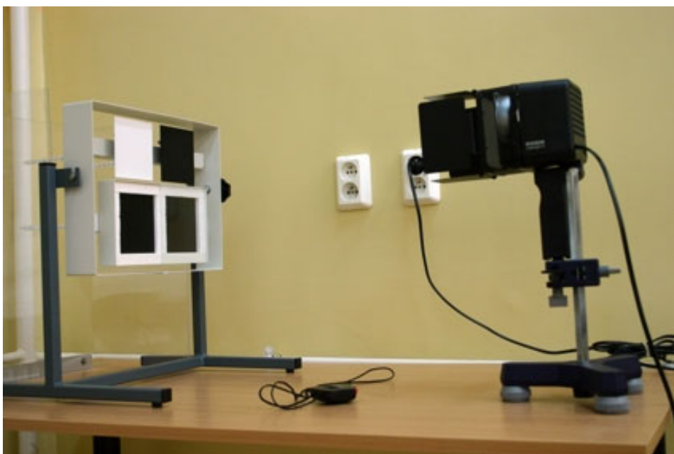
Rysunek 7.4. Aparatura do badań porównawczych absorberów kolektorów słonecznych
